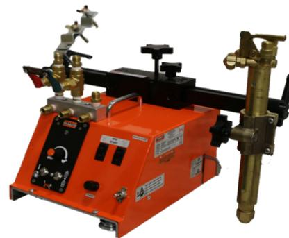
Der GK-100-FC Schneidtraktor wurde für Schneidanwendungen mit Flamme konzipiert. Durch die stabile Brennerhalterung und die konstante Geschwindigkeit des Traktors, können Sie nahezu perfekte Brennschnitte durchführen.
